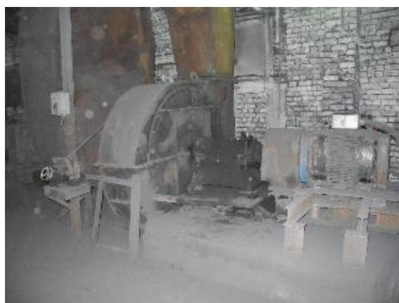
Рисунок 3.1.14 – Дутьевые вентиляторы
