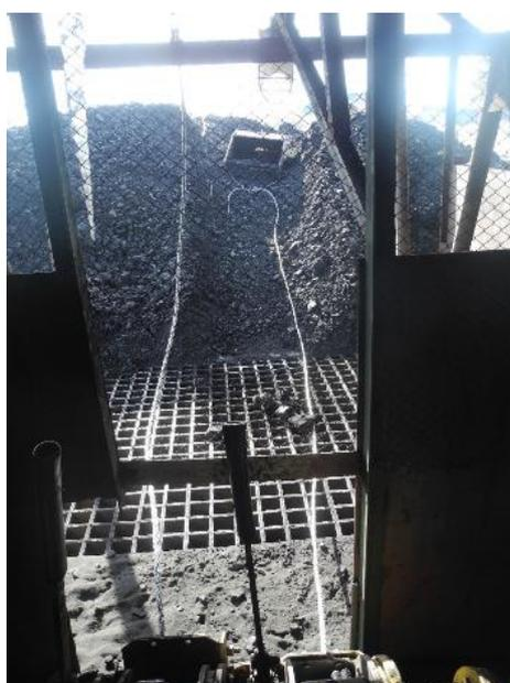
**Рисунок 3.1.62 – Скреперная лебедка топливоподачи**
