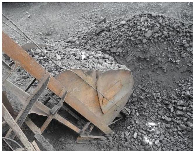
**Рисунок 3.1.96 – Сиповый подъемник**
