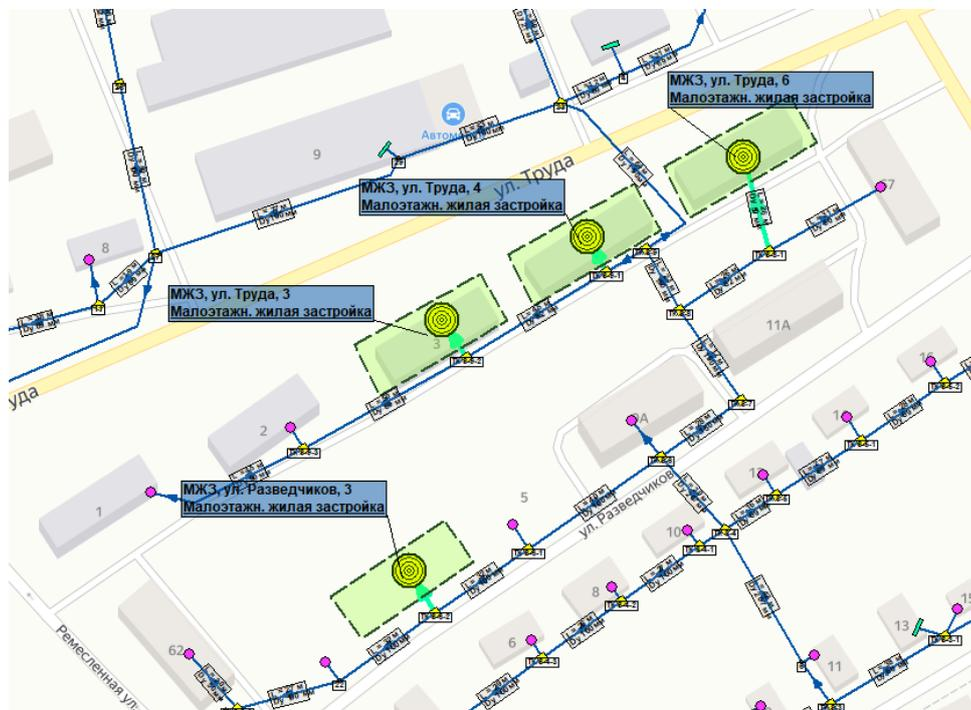
Рисунок 6.2 – Предложения по строительству тепловых сетей для обеспечения перспективных приростов тепловой нагрузки
