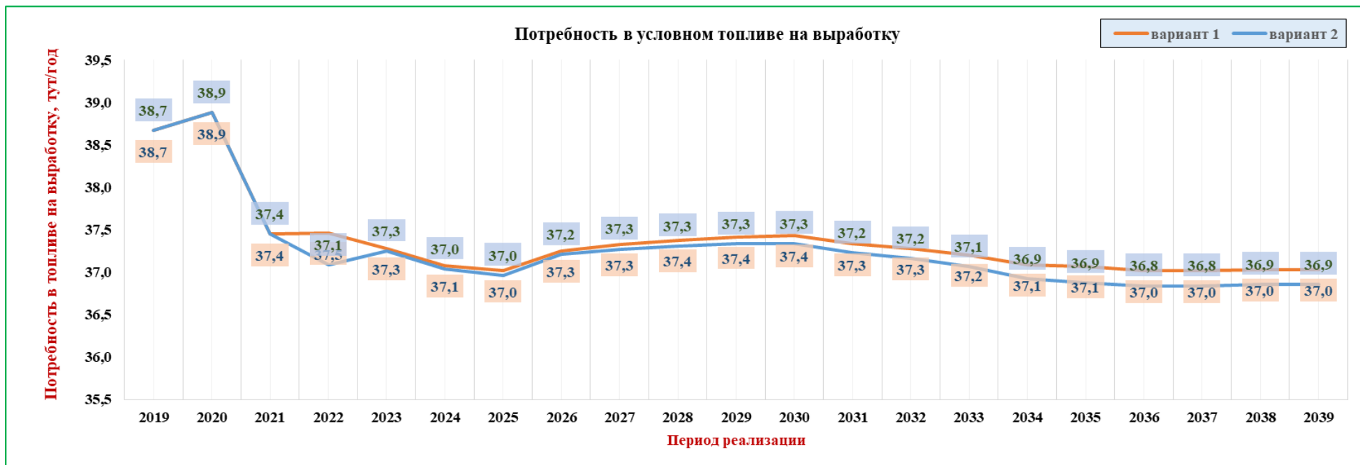
Рисунок 5.10 –Технико-экономическое сравнение вариантов перспективного развития систем теплоснабжения – Потребность в условном топливе на выработку
