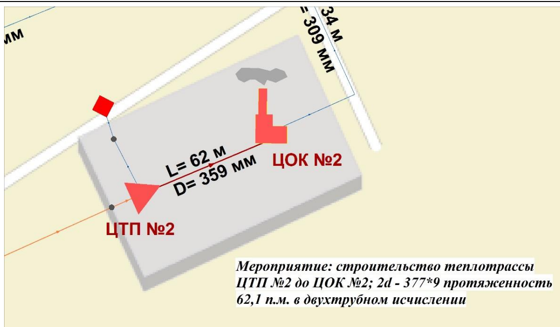
Рисунок 5.2 – Строительство теплотрассы ЦТП №2 до ЦОК №2
